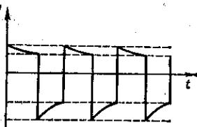
периода этих Р. к. происходят два медленных изменения силы тока  $I$  при заряде и разряде конденсатора и два быстрых — скачкообразных — изменения тока  $I_c$ , когда лампа зажигается и гаснет (рис.).
