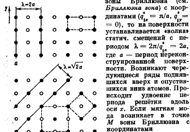
Рис. 4. Примеры реконструкции поверхности (100) кубического кристалла: а — реконструкция за счёт мягкой моды в точке X зоны Бриллюэна; новая элементарная ячейка показана пунктиром; б — реконструкция за счёт мягкой моды в точке M зоны Бриллюэна; новая элементарная ячейка показана пунктиром.
