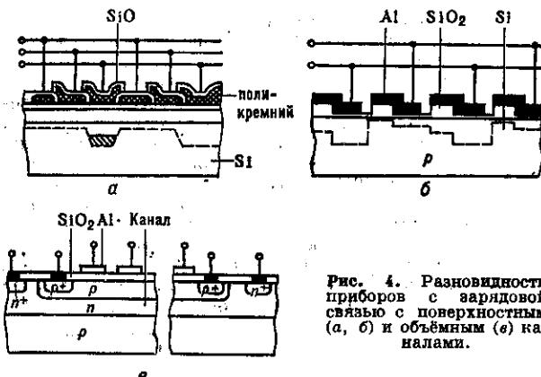
Рис. 4. Разновидности приборов с зарядовой связью с поверхностным (а, б) и объёмным (в) каналами.
