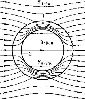
Экранирующее действие полого цилиндра из ферромагнитного вещества с  $\mu \gg 1$  (1 — внешн. поверхность цилиндра, 2 — внутр. поверхность). Остаточное магнитное поле внутри цилиндра  $B_{\text{внутр}} \ll B_{\text{внешн}}$ .
