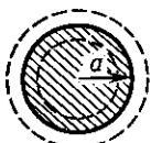
Рис. 1. Пульсирующая сфера (монополь).
