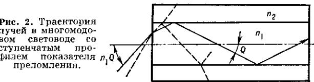
(рис. 2). При этом угол падения луча на торец световода составляет  $n_1 \theta$ .
