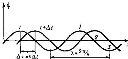
Рис. 1. Распределение в пространстве волновой переменной в бегущей синусоидальной волне в моменты времени  $t$  и  $t + \Delta t$ .
