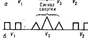
Рис. 7. Форма выходного сигнала V_3 при свёртке: а — двух прямоугольных и б — двух пар прямоугольных импульсов V_1 и V_2 .
